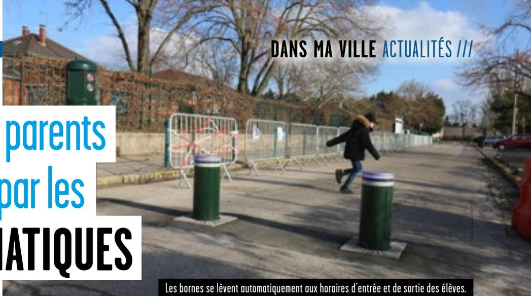
Les bornes se lèvent automatiquement aux horaires d'entrée et de sortie des élèves.
