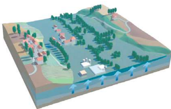
Figure 17 : Inondation par remontée de nappe
