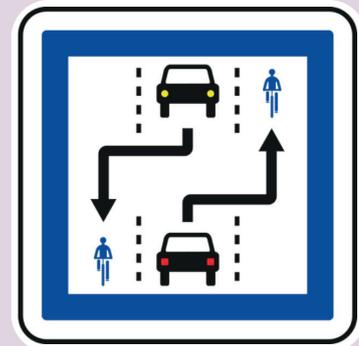
Contraction de « chaussée pour les circulations douces », le terme chaucidou désigne un aménagement consistant à supprimer le marquage axial de la chaussée pour l'entourer par des couloirs utilisés par les cyclistes. Bien que les automobilistes puissent s'y déporter ponctuellement pour laisser passer un véhicule arrivant en face, ils doivent néanmoins laisser la priorité aux cyclistes circulant dans ces couloirs.
